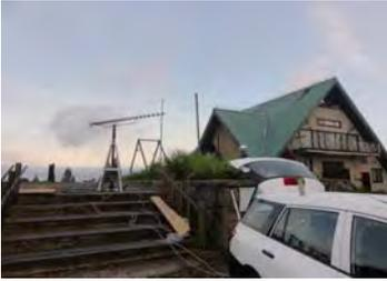
屋外における混信調査として、三重県青山高原にて高さ10mの電動伸張ポール(ユアサ工機製TPM-10)を使用し、高指向性アンテナ(30エレパラスタック八木)を回転して方位受信特性を調査したものです。
