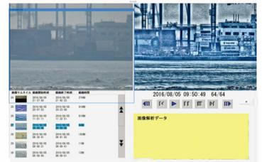
鮮明化映像例：霧の発生した海上における船舶映像の鮮明化
